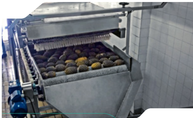
2 - Lavadora de frutas com escovas de nylon e sprays de água
